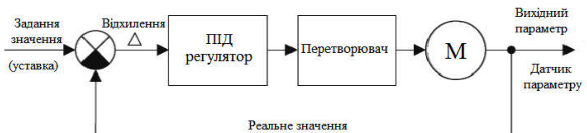
Рис. №1 «Використання ПІД – регулятора у системі керування насосною водовідливною установкою залізорудної шахти»
