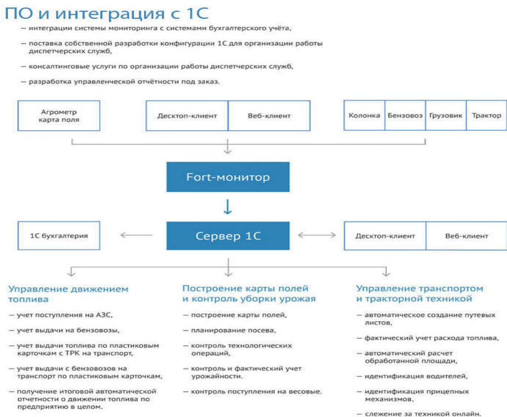
Рис. 1 Схема программного продукту від ТОВ Мікро Тронік на базі платформи «1С Підприємство 8» [3].
