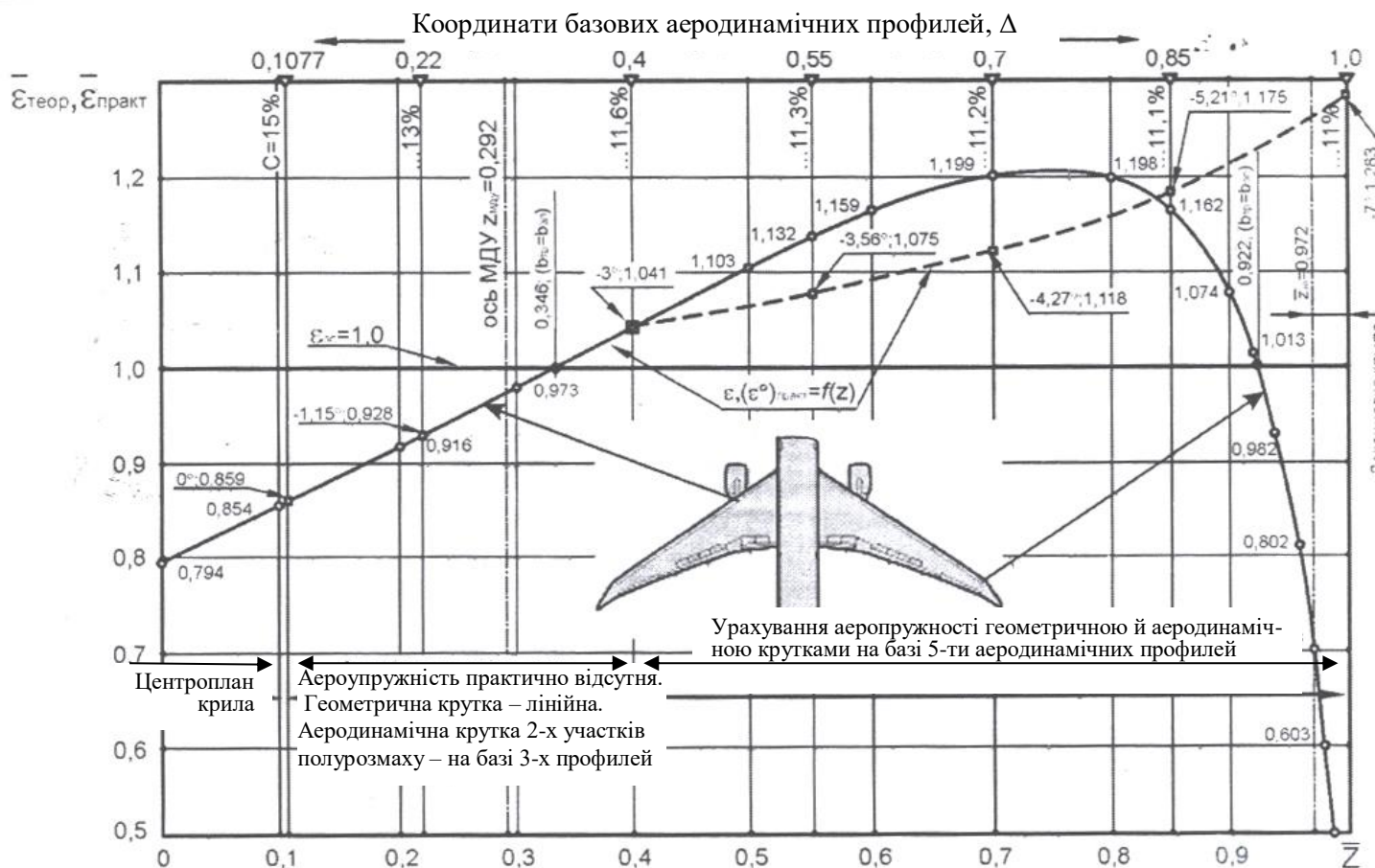
Рисунок 2 – Значення кутів геометричної кривки по піврозмаху крила, план якого утворений трьома трапеціями
