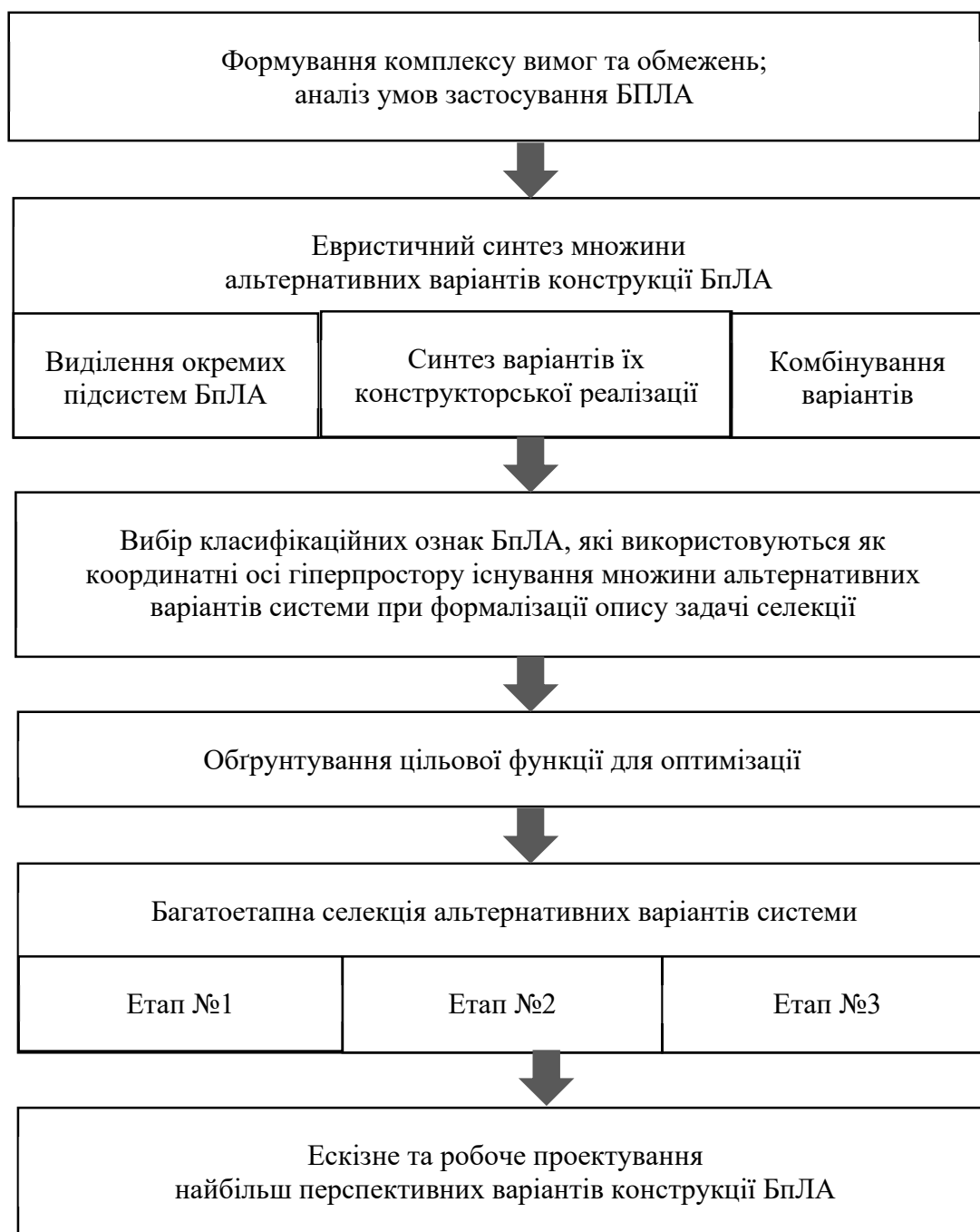
Рисунок 1. Укрупнений алгоритм методу зовнішнього проектування БПЛА
